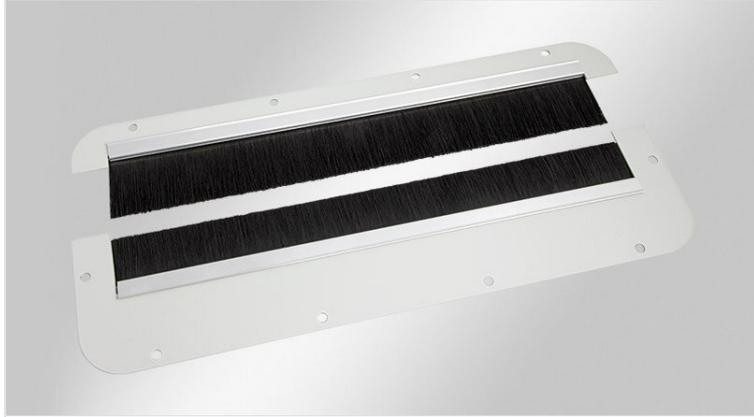
2分割式フランジプレートは、それぞれ2本のブラシストラップが反対方向に配置され、トリムの高さが異なります(1x35mm・1x50mm)。また、コネクタ付きのケーブルを挿入することができ、筐体への汚れの侵入を防ぎます。
